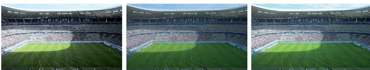
Bild 3: (3.1) Aufnahme mit der Kamera-Transferkurve, (3.2) gleiche Aufnahme mit globalem Tonemapping-Operator bearbeitet, (3.3) gleiche Aufnahme mit globalem Tonemapping-Operator und virtueller Blende
